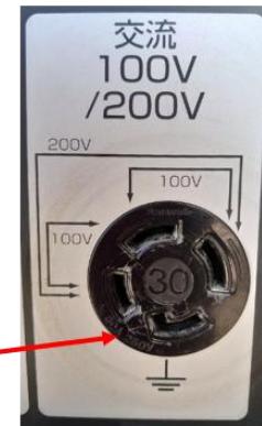
専用ケーブルゴムキャップ引掛部 (アース)を発電機コネクタ設置部 (アース)に合わせて差し込み右側に回す
