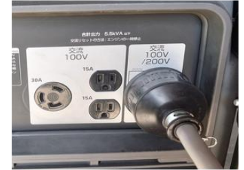
ゴムキャップ側(オス)を 発電機のコネクタ(メス) に差し込んで右側に回す
